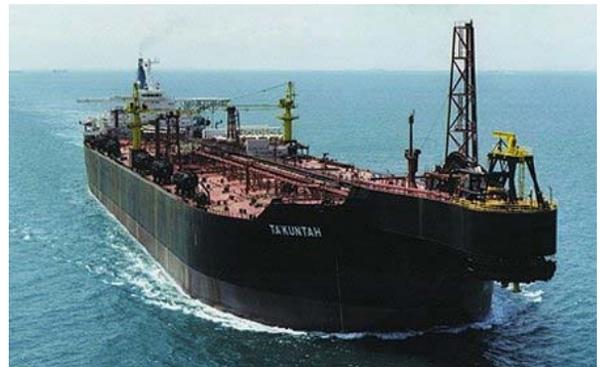
El FSO es capaz de surtir de petróleo a dos buques tanques simultáneamente por lo que cuenta con el sistema de medición con mayor capacidad instalada con una velocidad promedio de 120 mil barriles por hora de descarga de operación. Tiene una capacidad de exportación promedio de 281 mil barriles por día y una cuota de recibo de 345 mil barriles por día. Se encuentra bajo un contrato de servicios con PEMEX Exploración y Producción, haciéndose cargo la paraestatal de llevar a cabo sus operaciones.
